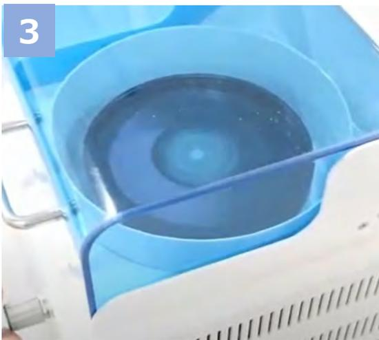
3 スピンコーターを回転させて液をひろげる
